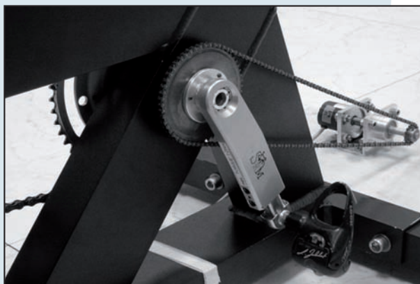
Foto A Particolare dell'encoder rotazionale applicato all'SRM.
